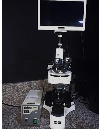
Microscopio de Epifluorescencia Marca Bioimager /BUM500FL.
