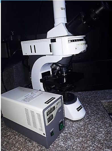
Microscopio de Epifluorescencia Marca Bioimager /BUM500FL.
